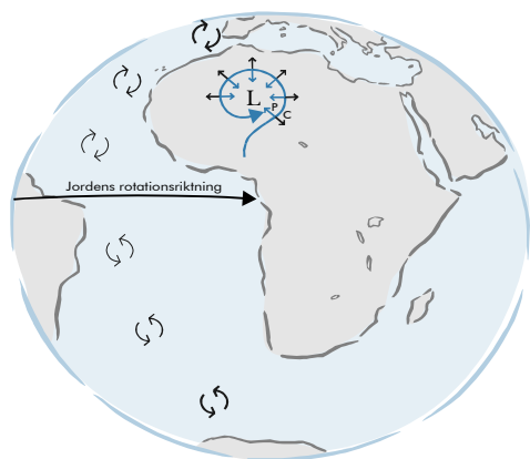
Figur 50. Figuren visar hur vindar, vatten och is – ja alla kroppar i rörelse på jordytan – som sätts i rörelse på jorden beskriver en böjd bana, åt höger på norra halvklotet och åt vänster på södra halvklotet. Corioliseffekten är proportionell mot rörelsens hastighet, dvs. ju högre kroppens hastighet är, desto mer avlänkas rörelsen. Trots att Corioliskraften verkar medurs på norra halvklotet får den luften att cirkulera moturs runt ett lågtryck.
